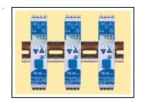
ТВ 45 – ограничитель температуры с функциями наблюдения применяется при прецизионном контроле процессов нагрева и охлаждения. Работает со всеми типами термоэлементов и терморезисторов. Каждый прибор имеет минимум один универсальный вход и два выходных реле. Опционально (на заказ) возможна комплектация аналоговым выходом для индикации. Входы гальванически разделены с выходами, питанием и интерфейсами.
