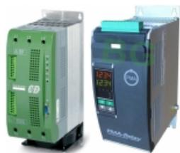
Серия трехфазных регуляторов мощности (с регулированием по двум фазам) для нагрузки, включенной в «звезду без нейтрали» или «треугольник». Регуляторы предназначены для регулирования мощности резистивных и инфракрасных нагревателей по принципу ВКЛ-ВЫКЛ при переходе напряжения через ноль. Применение этих регуляторов представляет собой наиболее экономичное решение.
