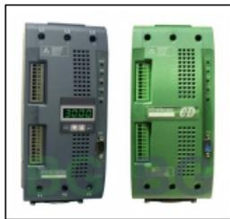
Серия трехфазных регуляторов мощности (с регулированием по двум фазам) для резистивной и индуктивной нагрузки, включенной в «звезду без нейтрали» или «треугольник». Регуляторы оснащены дисплеем и интерфейсом RS485 с протоколом Modbus, располагают аналоговыми и логическими управляющими входами и сервисными выходами, включая ретрансмиссию управляющего сигнала. Регуляторы имеют различные технологии коммутации тиристоров, а также электронный ограничитель максимального тока.
