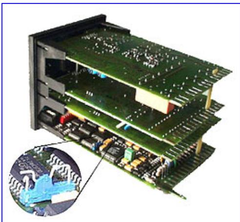
Кроме коррекции измерений (компенсации погрешности датчиков и погрешностей, вносимых соединительными проводами) входные и выходные сигналы могут быть масштабированы для вывода на индикатор реального значения параметра, также линейризованы или математически обработаны (извлечение корня). Регулятор KS 94 позволяет приспосабливаться к технологическому процессу без дополнительных приборов. На практике бывает оправдана искусственная подача помехи для улучшения регулирования, например, паровых котлов.
